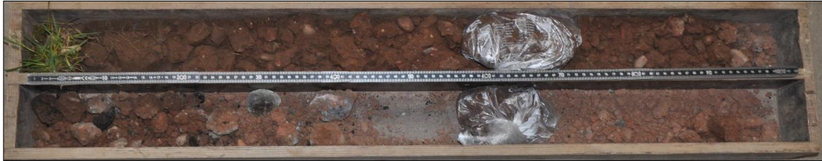
Foto 1: Erkundungsstelle 1 – Bohrgut Kleinrammbohrung
