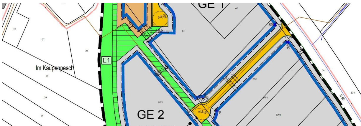
Abb. 3: Lage des Kanals innerhalb der Verkehrsfläche (Überlagerung Kanal mit Ausschnitt Planzeichnung Bebauungsplan, ohne Maßstab)
