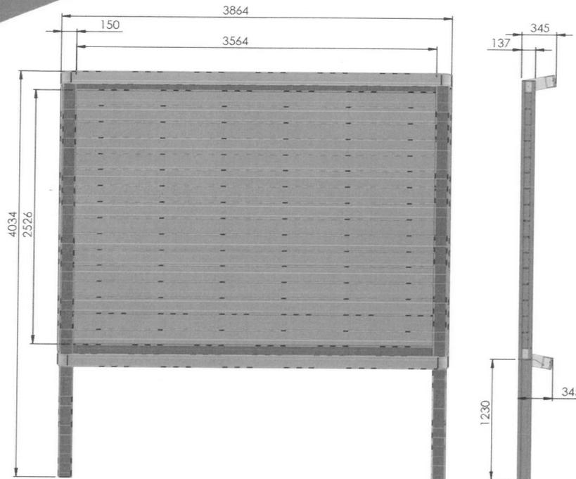
Der Großflächen-Werbeträger (Version: Freistehend) besteht komplett aus hochwertigem Aluminium, um allen Witterungseinflüssen standhalten zu können.
