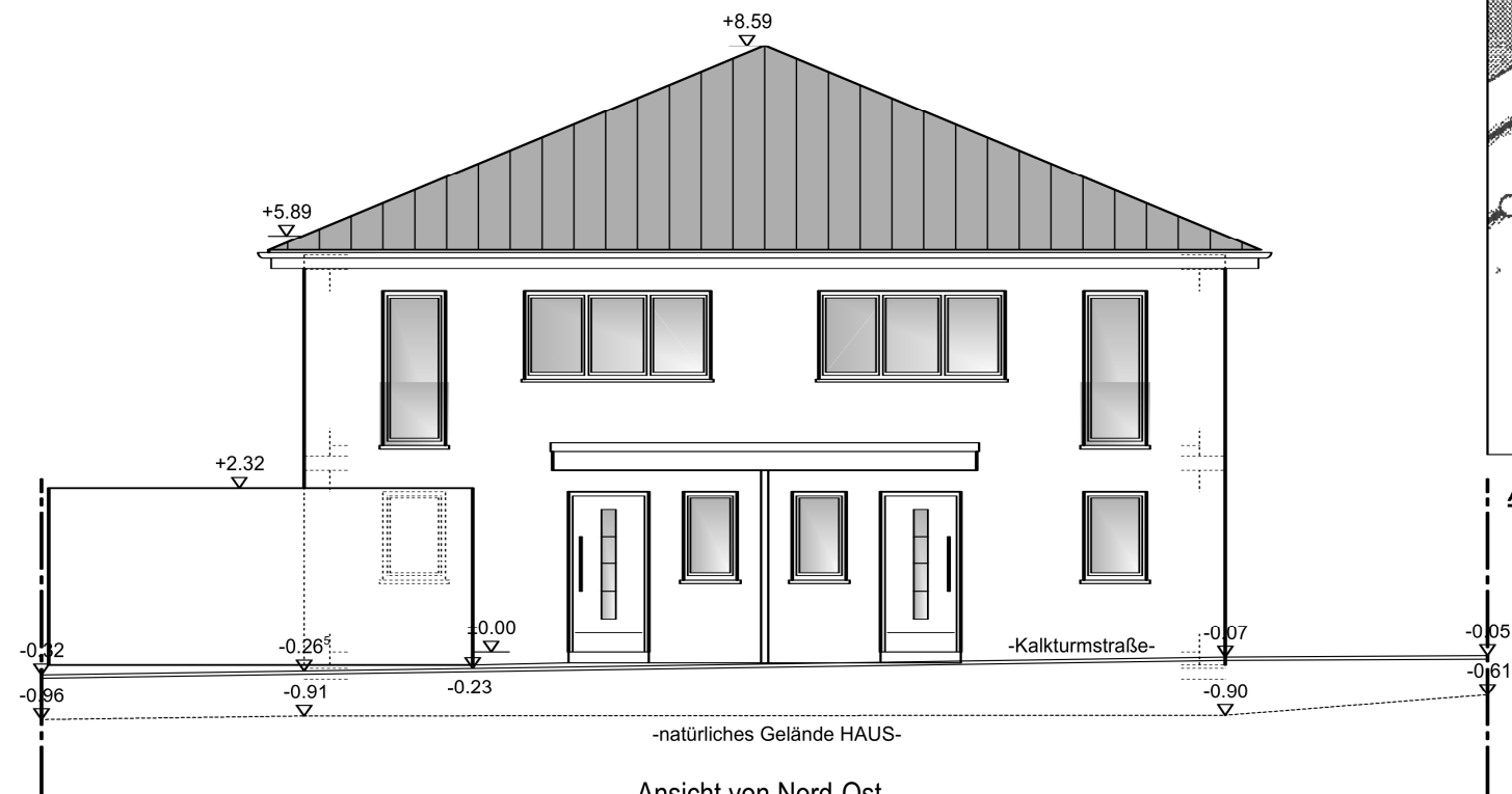
Ansicht von Nord-Ost T = (6,80+6,79) \times 0,5 \times 0,4 = 2,718 T_{min} = 3,00 \text{ m} Mittler Höhe Garage: (2,64+2,55) \times 0,5 = 2,595 < 3,20 \text{ m}
