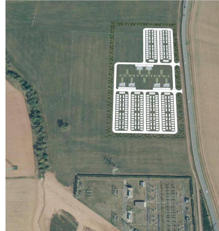
Projektvariante mit 300 MW / 600 MWh mit 6 Systemen vom Typ ES-50C
