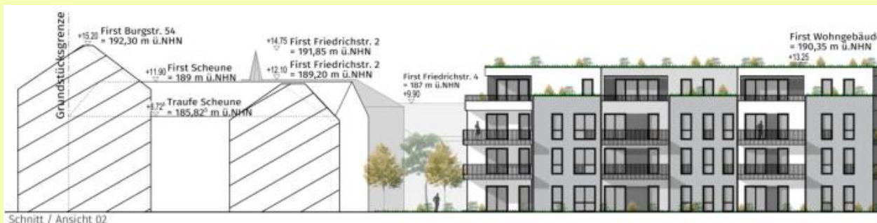
Abb. 25: Vergleich zwischen der vorhandenen Bebauung an der Burgstraße und dem geplanten Bauvorhaben
