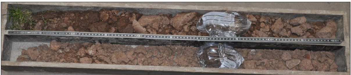
Foto 8: Erkundungsstelle 3 – Bohrgut Kleinrammbohrung
