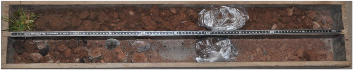
Foto 1: Erkundungsstelle 1 – Bohrgut Kleinrammbohrung
